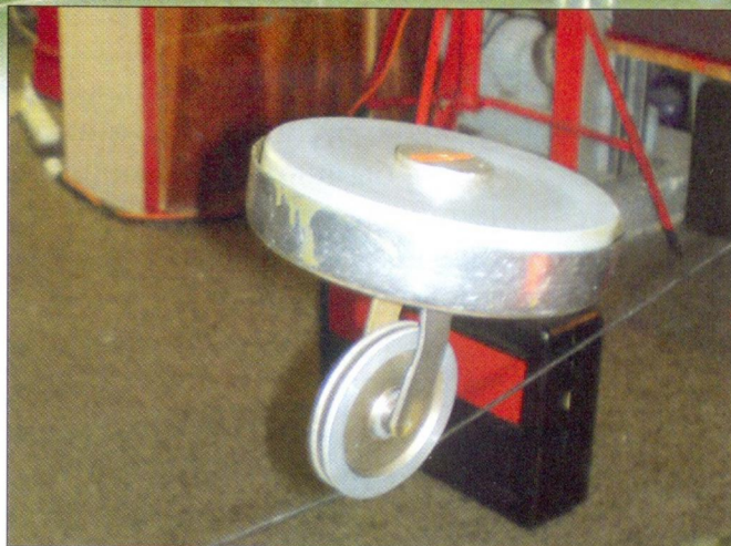
Вращающийся волчок (гироскоп) демонстрирует свою устойчивость и реально стоит на тросе
